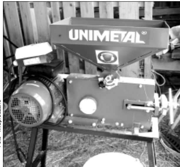
Graudu placinātājs. Ar šo agregātu saimniecībā “Baķi” turpmāk pārstrādās graudus, nodrošinot aitām pilnvērtīgu barības izmantošanu.
